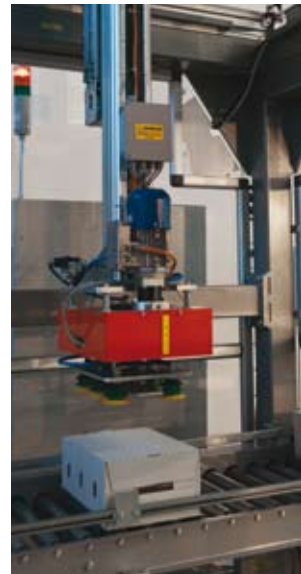
- dettaglio testa di presa - detail of picking head - détail tête de prise
